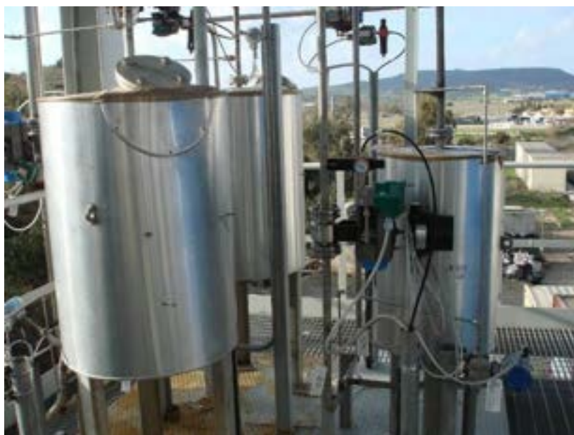
Figura 1.3. Sistema di desolforazione a caldo del syngas.
