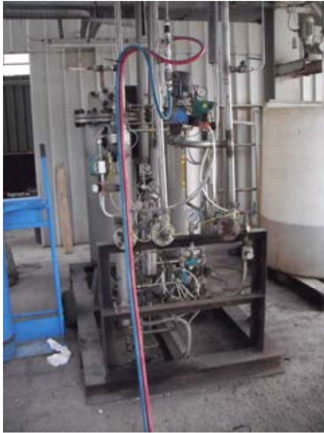
Figura 4.11 Prova funzionamento PSA con gas tecnici
