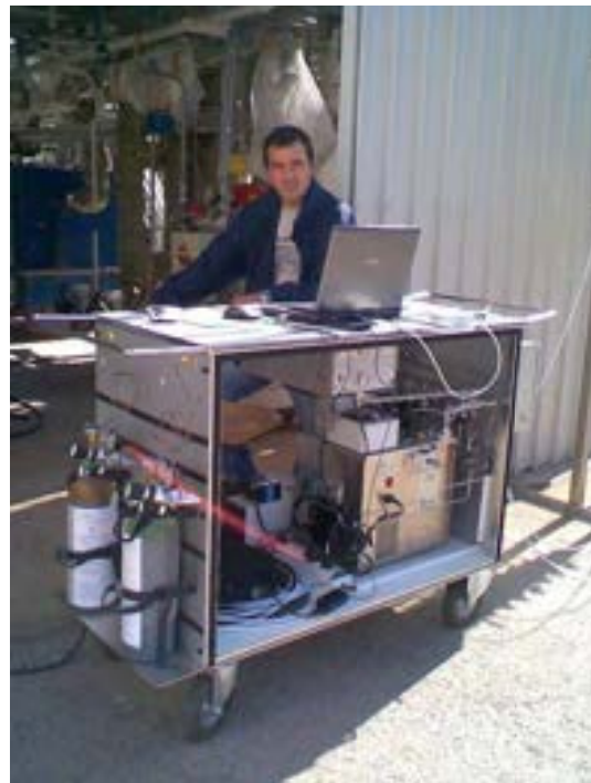
Figura 15 - Laboratorio mobile di analisi gas ENEA e carrello di prelievo e analisi gascromatografica
