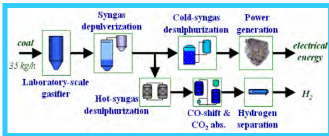
Figura 12: Schema di flusso semplificato dell'impianto pilota.
