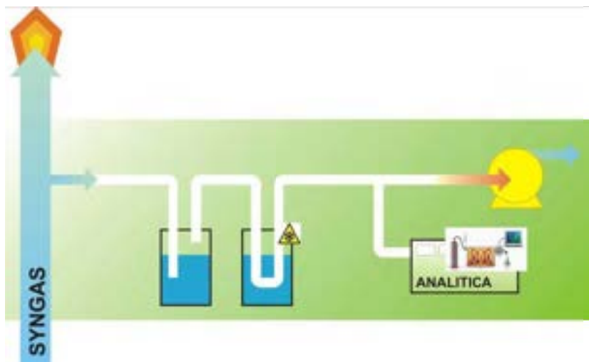
Figura 3: Schema della linea di campionamento
