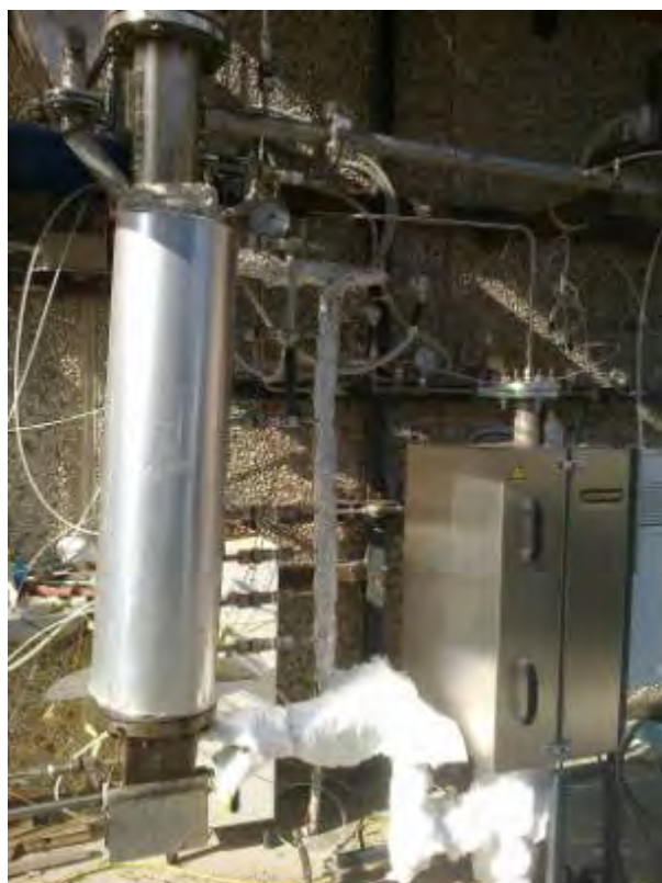
Figura 6: allestimento del set up sperimentale gassificatore e forno di preriscaldamento
