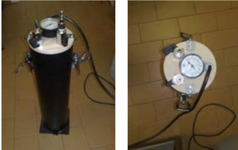
Figura 4. Camera iperbarica costruita ed utilizzata per i test di laboratorio ad alta pressione. Si osservano il manometro di controllo e i diversi rubinetti per le variazioni delle condizioni di temperature e concentrazione.
