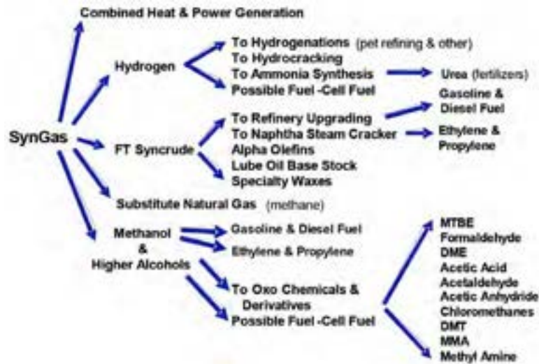
Figura 1: Principali prodotti ottenibili dal gas di sintesi
