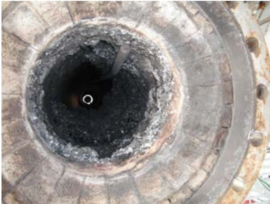
Figura 2.3.1 .refrattario pareti interne del gassificatore
