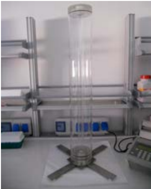
Fig. 20. Fotobioreattore a colonna per la sperimentazione dei batteri fotosintetici anossigenici.
