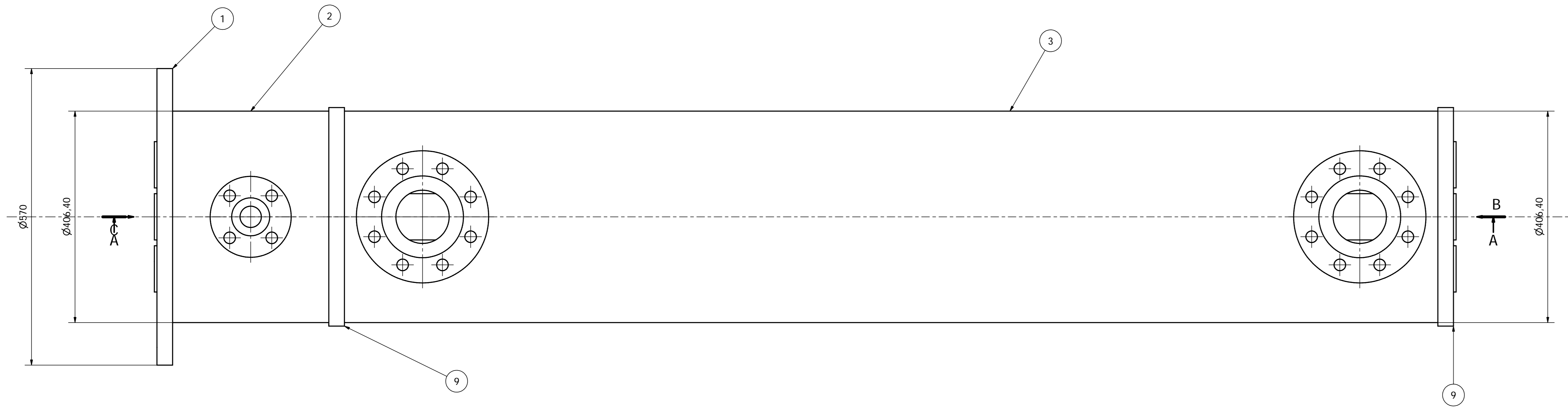
DETTAGLIO 9 Lavorazioni di foratura sulle Piastre Tubiere Intermedia e Bassa
