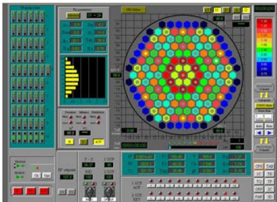
Fig. 5-8 Quadro del controllo di reattività (CPS)
