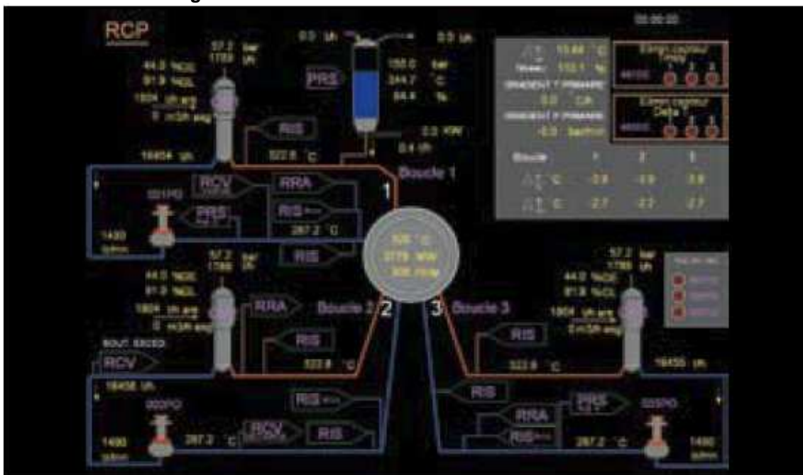
Fig. 3-11 Rappresentazione schematica di un PWR da 900 MWe
