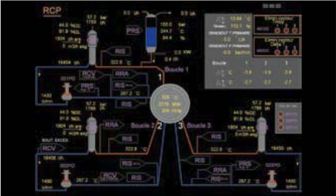
Fig. 5: Rappresentazione schematica di un PWR da 900 MWe.
