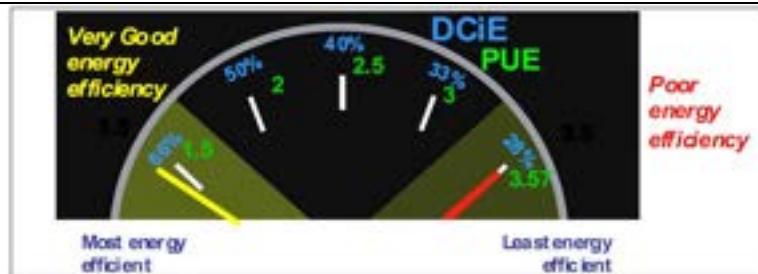
Figura 5: Misure relative di DCiE e PUE [32]
