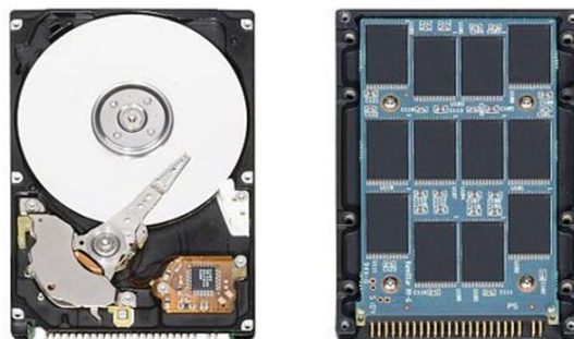
Figura 13: Le due tipologie principali di sistemi di storage HDD e SSD [59]
