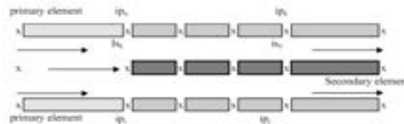
Fig. LP5-C1A - 8: Nodalizzazione di una struttura EXCHANGER
