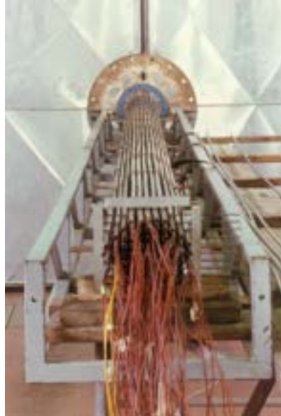
Fig.C1-5 SPES: Fascio di Barre del Canale di Potenza con Termocoppie
