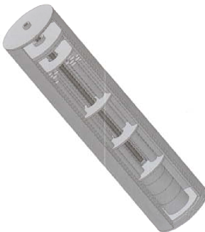
Fig. 1: proposta di capsula per prove di annealing
