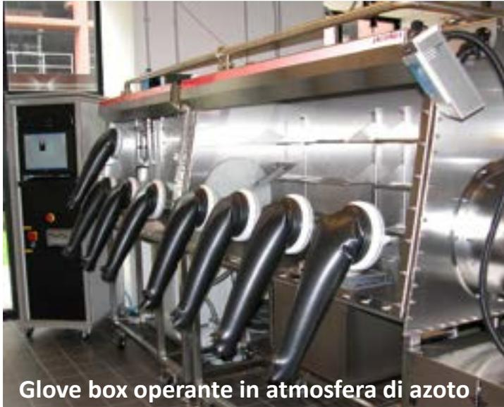
Glove box operante in atmosfera di azoto
