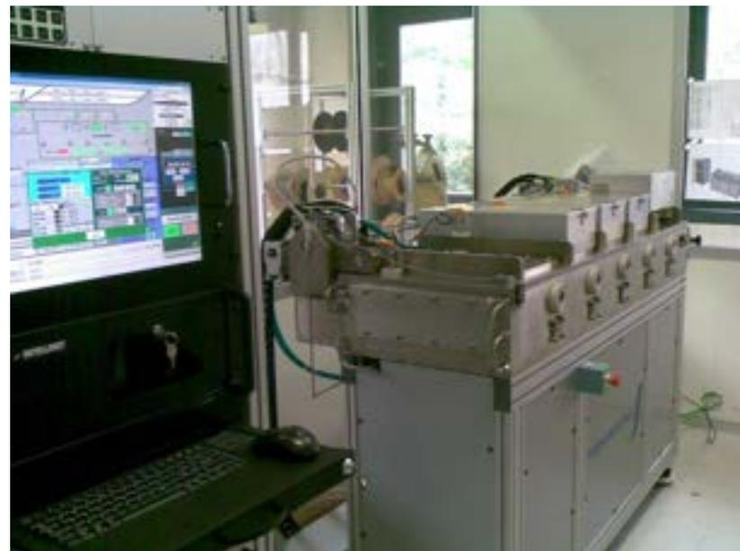
Nuovo impianto di sputtering per la deposizione di Mo e ZnO e ZnO:Al.
