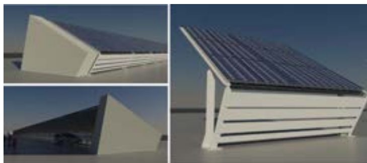
Figura 4 - Restituzione grafica della centrale FV e del singolo cavalletto. (Fonte. L.Reguzzoni - "La Comproprietà fotovoltaica: una via per lo sviluppo del Fotovoltaico nei centri storici e nei centri abitati", 2008).
