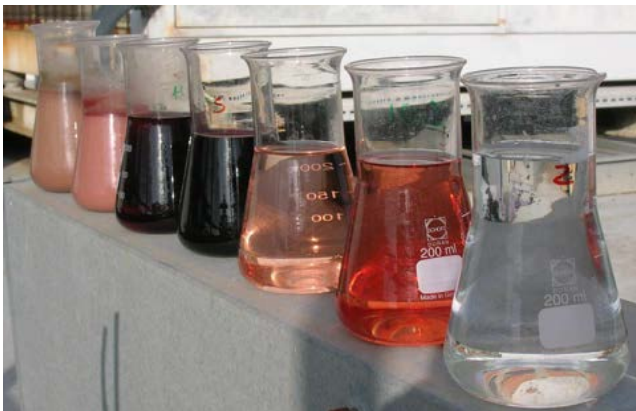
Figura 21. Frazioni separate in MF, UF, NF ed OI a partire dalle AV olearie
