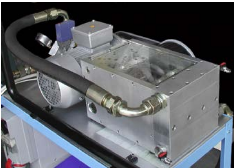
Figura 25. La nuova pompa Triplex a flusso continuo (1 m 3 /h, 30 Bar, motore da 1.1 kW)
