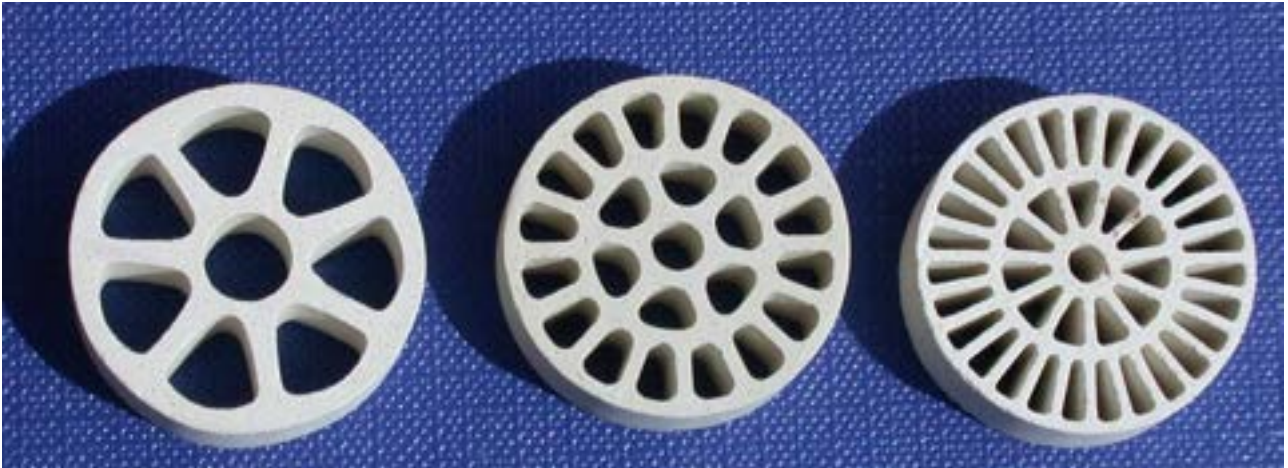
Figura 8. Sezione trasversale di membrane tubulari ceramiche
