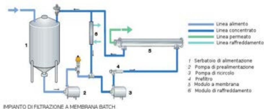
Figura 13. Schema di impianto pilota batch
