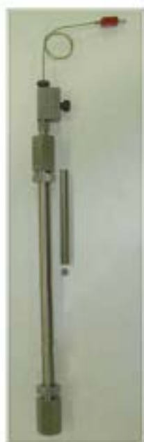
Figura 9 - Microreattore con cestello per il catalizzatore, porous plate e termocoppia.
