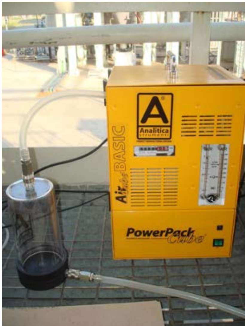
Fig. 7 – Campionatore Air Cube Basic utilizzato nelle prove preliminari per il campionamento del TAR
