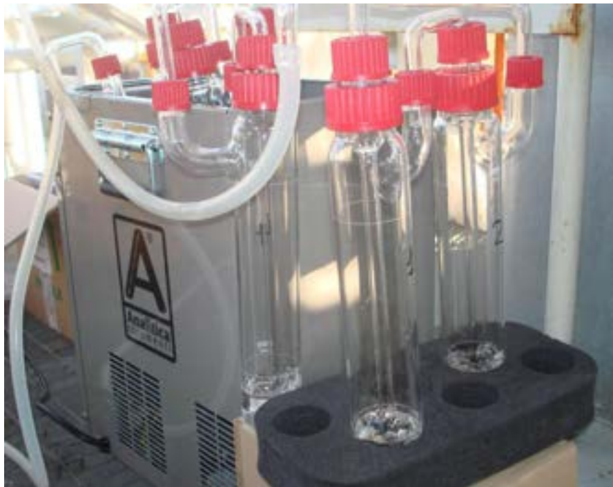
Fig. 6 – Sistema di sei assorbitori collegati in serie per la separazione del TAR dal syngas da gassificazione del carbone
