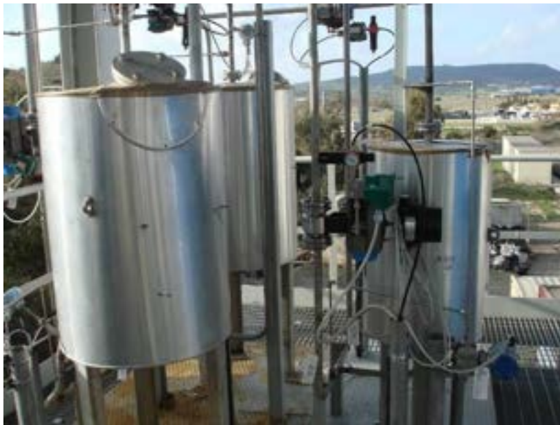
Figura 2.5. Sistema di desolfurazione a caldo del syngas.
