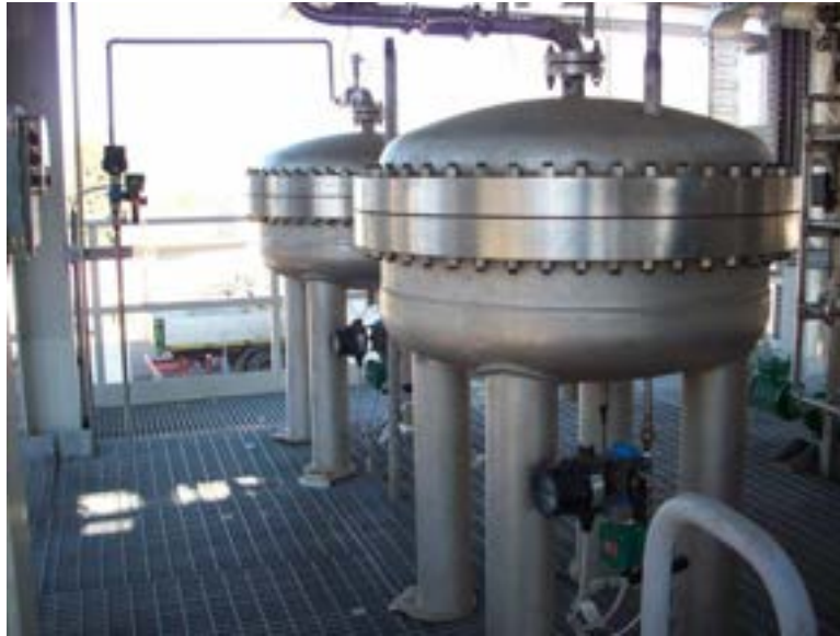
Figura 2.8. Reattori di assorbimento dell'anidride carbonica.
