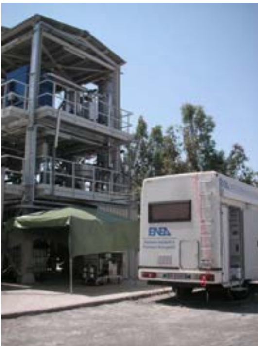
Fig. 18 – Laboratorio mobile di analisi gas ENEA e carrello di prelievo e analisi gascromatografica
