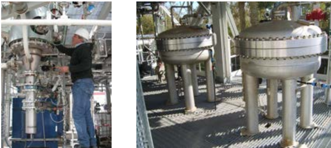
Fig. 14– Impianto Laboratorio: dettaglio del gassificatore dei due reattori di cattura della CO 2 .
