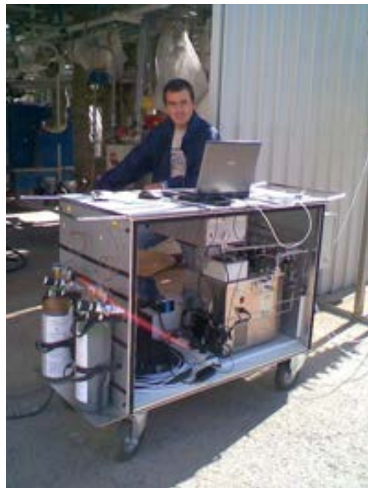
Fig. 18 – Laboratorio mobile di analisi gas ENEA e carrello di prelievo e analisi gascromatografica
