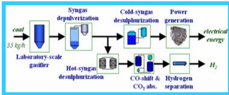
Fig. 13– Impianto Laboratorio: schema semplificato del processo di produzione e trattamento syngas
