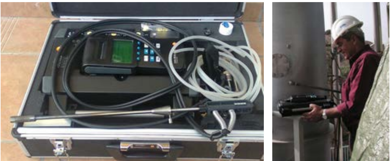
Fig. 19 – Sistema di analisi basato su celle elettrochimiche
