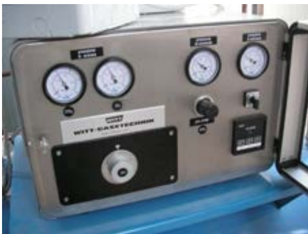
Fig. 16 – Dettaglio miscelatore ossigeno e CO 2
