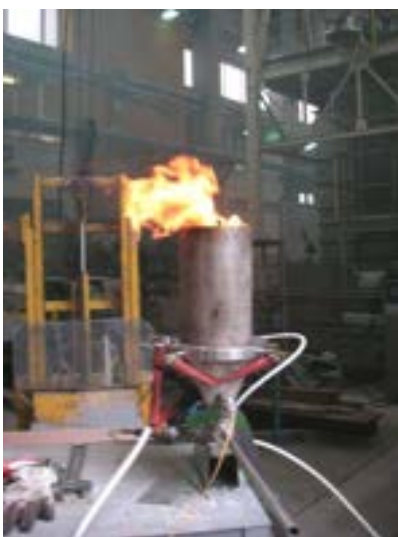
Fig. 6 – Nuove linee di adduzione gas equipaggiate con misura di temperature, pressioni e portate
