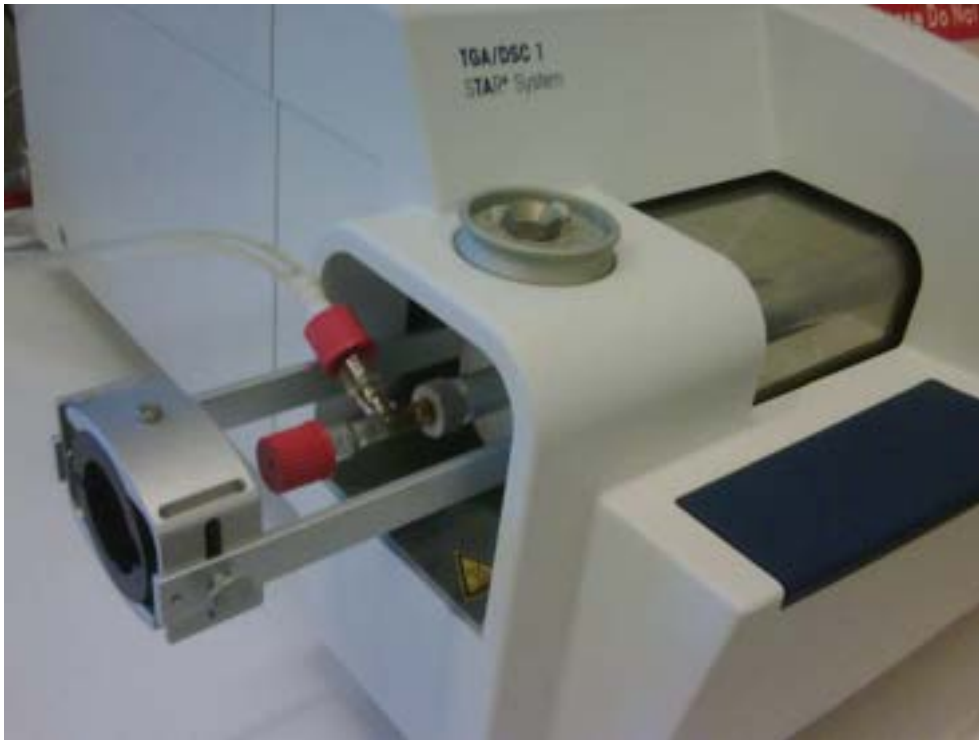
Figura 7a: Accessorio di campionamento per l'interfaccia con MS
