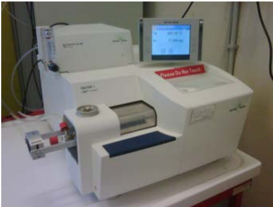
Figura 4: bilancia termogravimetrica modello Mettler-Toledo TGA-DSC1
