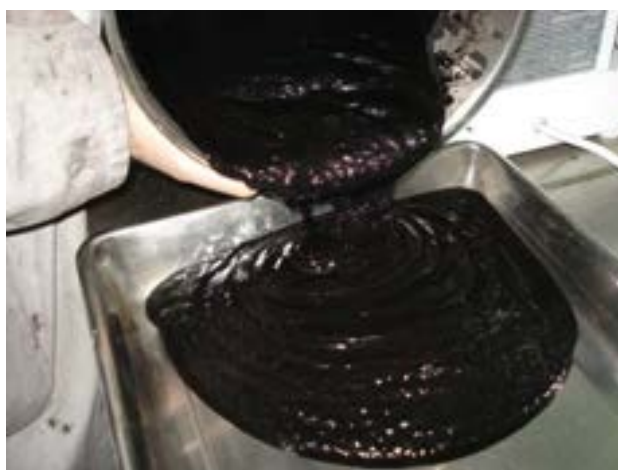
Figura 19. Consistenza tipica della miscela CW (Sulcis 70/30 con proporzione di carbone del 60%).
