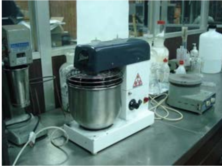
Figura 6. Miscelatore orbitale usato per la preparazione delle miscele CW
