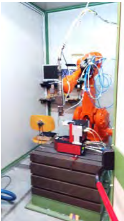
Figura 26: UniSalerno, impianto Teseo, (SX) robot, testa di focalizzazione e diagnostica laser (Primes FM/PM), (DX) sorgente e quadro mobile Enea.
