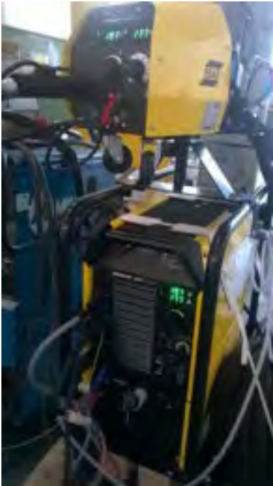
Figura 17: gen. MIG Esab Warrior 400i e parametri di prova
