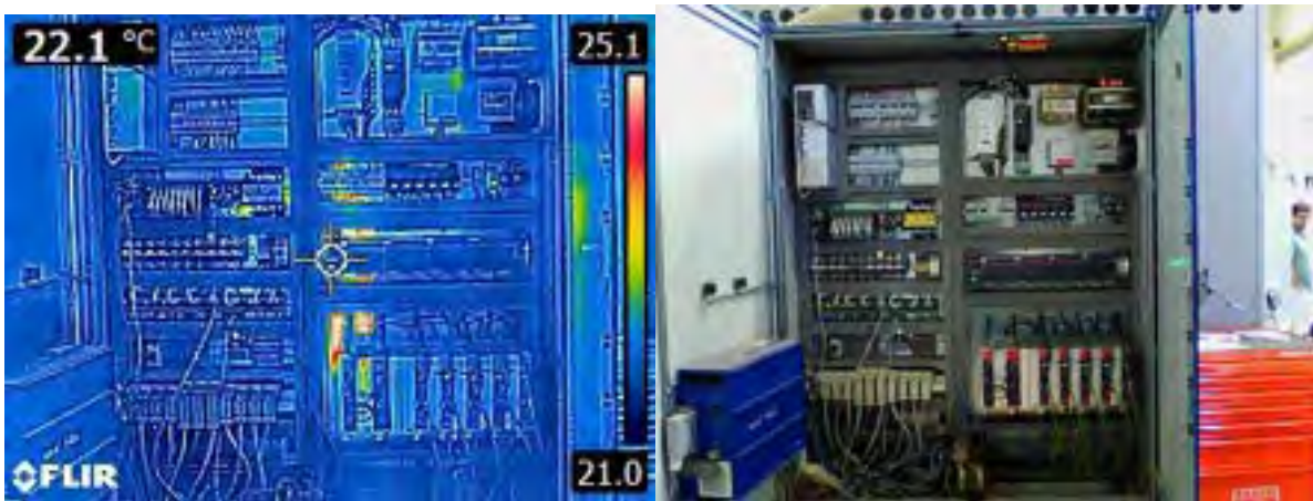
Figura 39: Monitoraggio degli armadi elettrici di potenza del Sistema di movimentazione TLW 2.1
