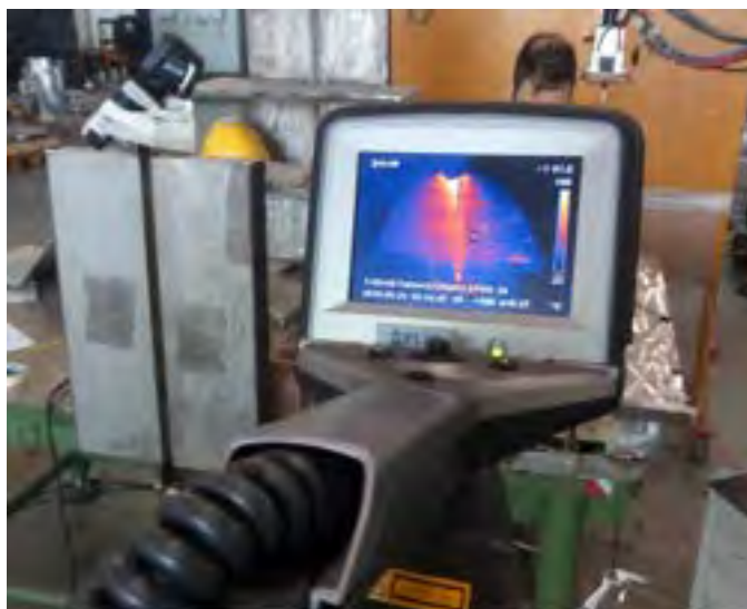
Figura 13: Set UP termo camere per acquisizione termografica durante il processo di saldatura semiautomatico TIG presso l'Azienda Walter Tosto
