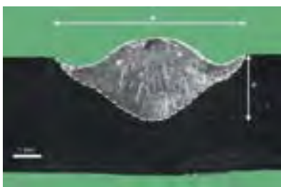
Figura 47: Sezione macrografica tipo e riepilogo dei dati di forma principali
