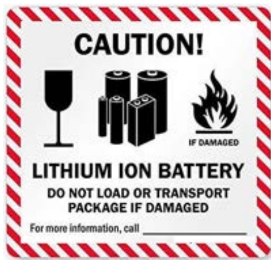
Figura 1. Pittogramma di precauzioni da prestare nel trasportare e maneggiare pacchi di batterie al litio
