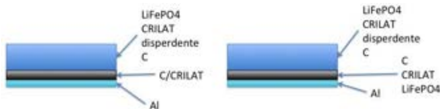
Figura 15: schematizzazione delle stese catodiche realizzate con due passaggi di deposizione dell'inchiostro.
