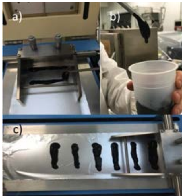
Figura 5: foto di alcuni momenti della preparativa: a) visione frontale del doctor blade; b) foto dello slurry che ne evidenzia la consistenza; c) modalità di distribuzione dello slurry sul foglio di alluminio prima dell'azionamento del doctor blade.
