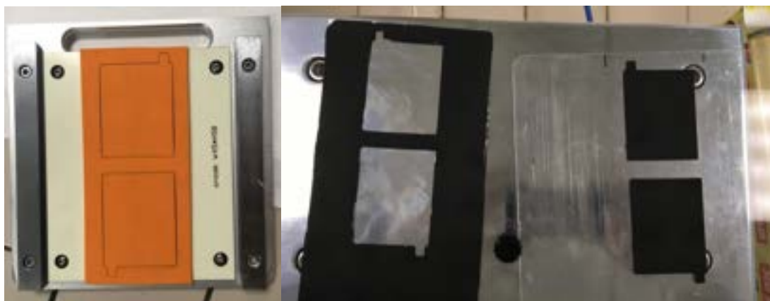
Figura 4: (sinistra) stampo per anodo. Nella fessura c'è una lama in grado di sagomare l'elettrodo; (destra) nastro catodico sagomato.
