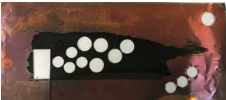
Figura 18: stesa anodica realizzata con grafite ad alta capacità (Linyi-Gelon)
