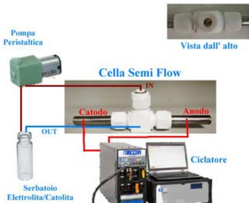
Figura 19. Schema del sistema di prova allestito per la misura delle celle semi flow.
