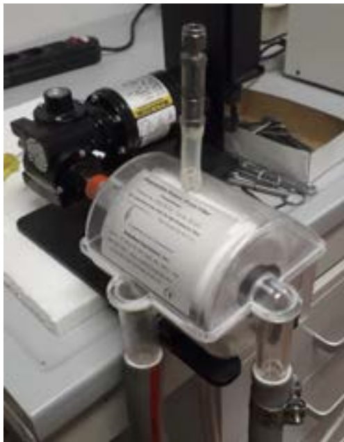
Figura 3. A sinistra: filtro a tamburo (Kappa Tau Filters). A destra disegno esemplificativo delle parti costituenti il filtro.
