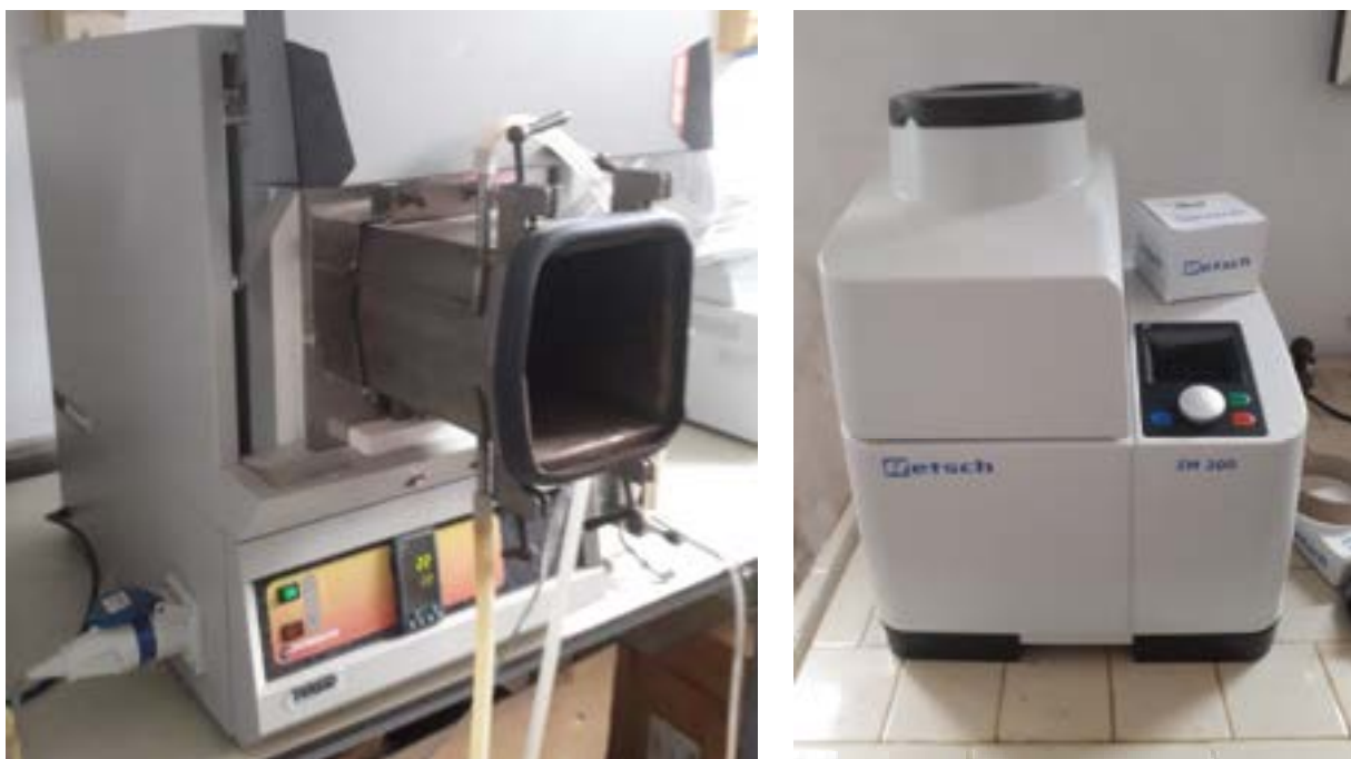
Figura 8. A sinistra: Forno Carbolite, in grado di raggiungere i 1100 C in atmosfera controllata. A destra: mulino della Retsch con rotore a 12 denti ed un setaccio in Conidur con fori da 0.5 mm.
