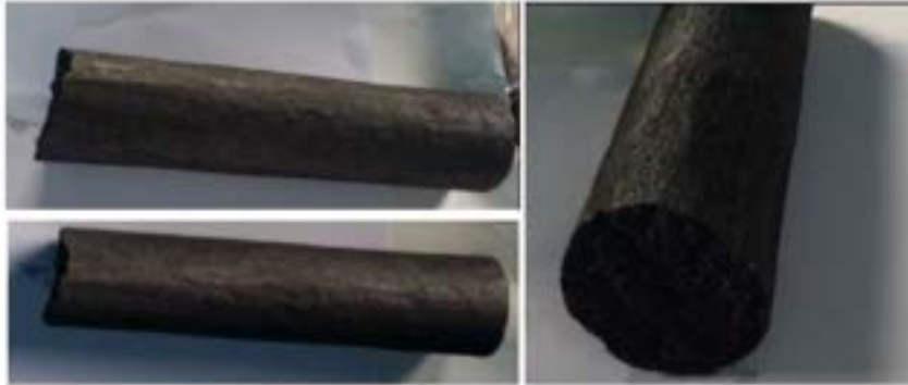
Figura 20. Grafite irradiata dal reattore rumeno TRIGA, utilizzata per gli esperimenti di lisciviazione.
