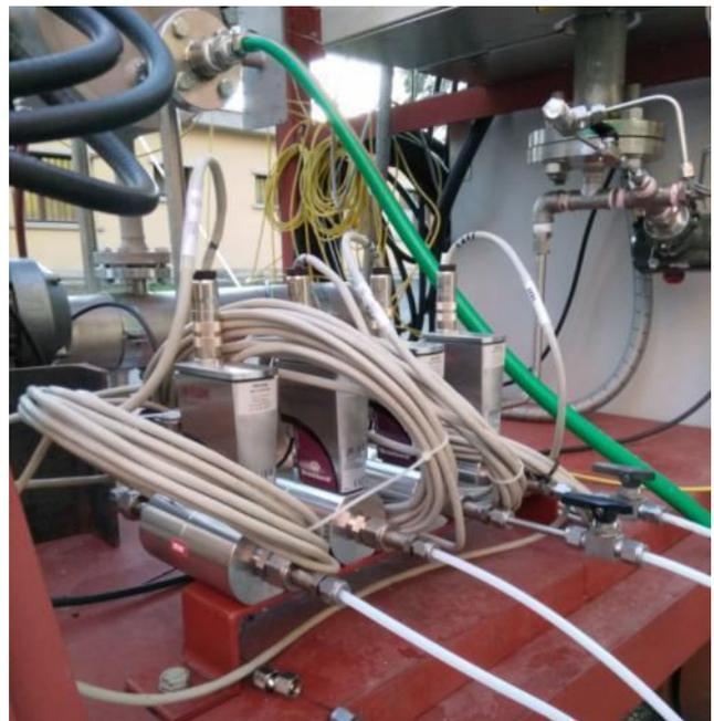
**Figura 7. Dettagli dello scambiatore a piastre e della nuova rampa dei gas di alimentazione**
