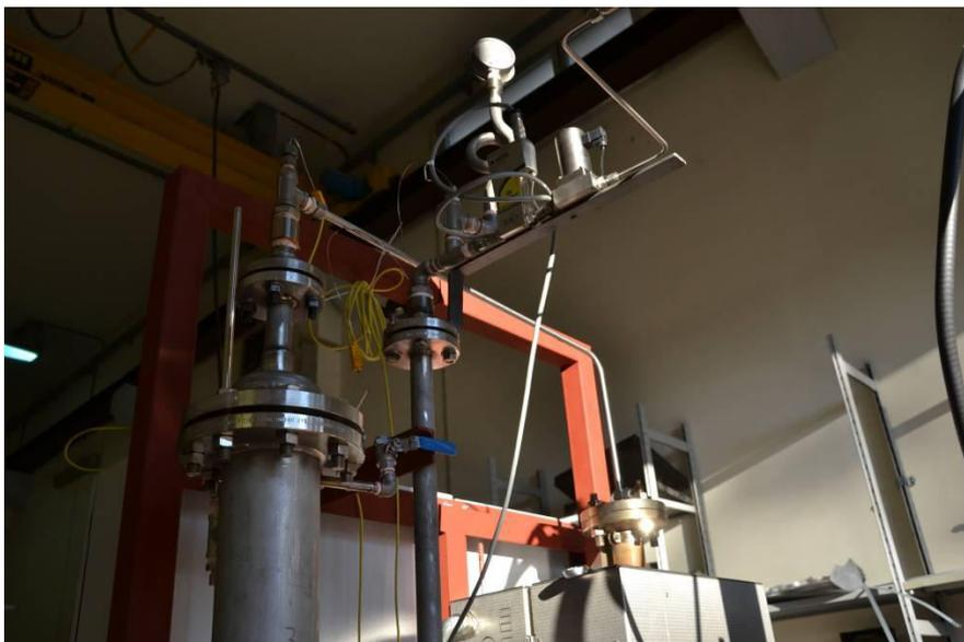
**Figura 4. Valvola di regolazione della pressione**
