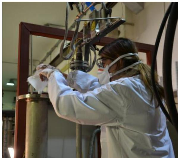
**Figura 8. Fase di caricamento del catalizzatore**
